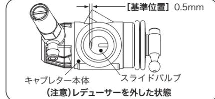
(注意) アイドル調整バルブ、及びメータリングニードルは工場出荷時に基準位置に調整済みですが、使用される燃料や気象条件などにより再調整が必要な場合があります。基準位置で運転されてみて良い結果が得られない場合は「キャブレターの調整」の項を参考に調整してください。
